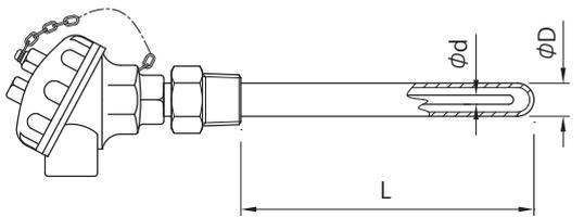
固定取付ネジ型式です。端子筐支管を無くし、取付スペースの狭い箇所や機械内部等に取付る仕様です。
