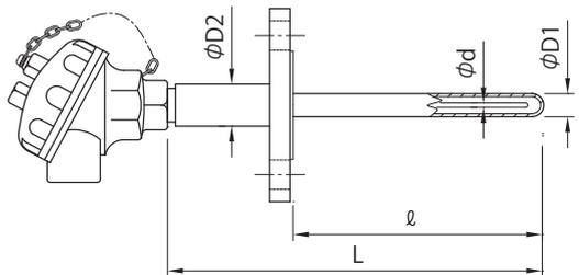
固定取付フランジ型式です。感度を良くするため保護管を細く、端子筐支管を太く頑丈にした仕様です。
