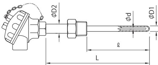
固定取付ネジ型式です。感度を良くするため保護管を細く、端子筐支管を太く頑丈にした仕様です。
