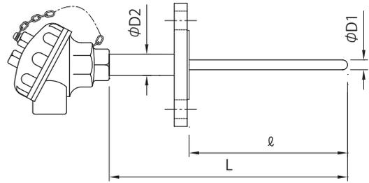
固定取付フランジ型式です。感度を良くするため保護管を細く、端子筐支管を太く頑丈にした仕様です。
