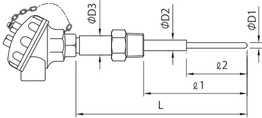
固定取付ネジ型式です。感度を良くするため磁性管の感応部を細く、また、磁性管を強固にするため、取付ネジ以降もソケットを配し、端子筐下支管をさらに太く頑丈にした仕様です。
