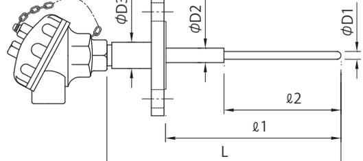
固定取付フランジ型式です。感度を良くするため磁性管の感応部を細く、また、磁性管を強固にするため、取付フランジ下もソケットを配し、端子筐下支管をさらに太く頑丈にした仕様です。
