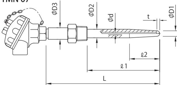
固定取付ネジ型式です。保護管をクリヌキにし、流体抵抗軽減、又、感度を良くするためテーパを付けた耐圧仕様です。
