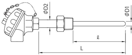
固定取付ネジ型式です。ネジ下すぐに磁性管を配した仕様です。
