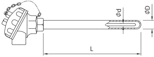
金属保護管の内側に磁性管を入れ二重にする事で、雰囲気(ガス等)と衝撃・振動からエレメントを保護する仕様です。摺動フランジ等で取付ます。
