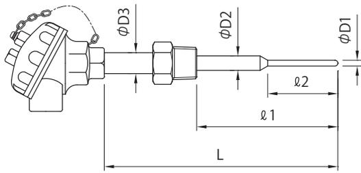
固定取付ネジ型式です。感度を良くするため保護管の感応部を細く、また、固定取付ネジまでのたわみを無くするためやや太くし、端子筐支管をさらに太く頑丈にした仕様です。
