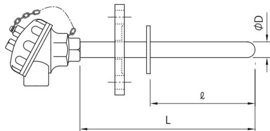
摺動取付フランジ型式です。主として保護管がレアメタルの場合に使用します。フランジを SUS304 等を使用する事により、比較的安価にするための仕様です。
