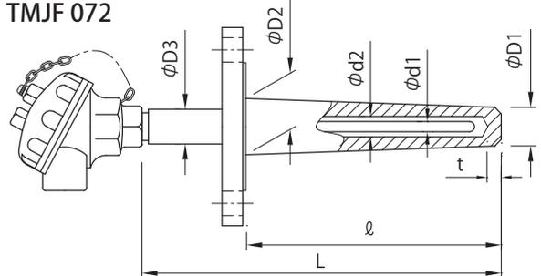
固定取付フランジ型式です。金属保護管をクリヌキにし、流体抵抗軽減、又、感度を良くするため、テーパを付けた耐圧仕様です。
