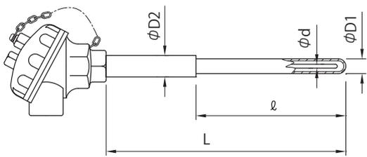
貴金属熱電対で 사용되는ことの多い、一般的な仕様です。磁性管が二重になっている分、強度も向上しています。摺動フランジ等で取付ます。
