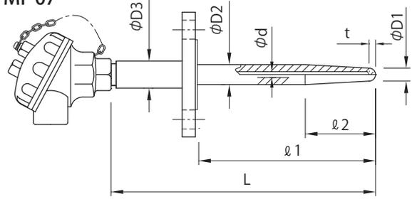
固定取付フランジ型式です。保護管をクリヌキにし、流体抵抗軽減、又、感度を良くするためテーパを付けた耐圧仕様です。
