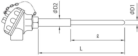
貴金属熱電対で使用されることの多い、一般的な仕様です。摺動フランジ等で取付ます。
