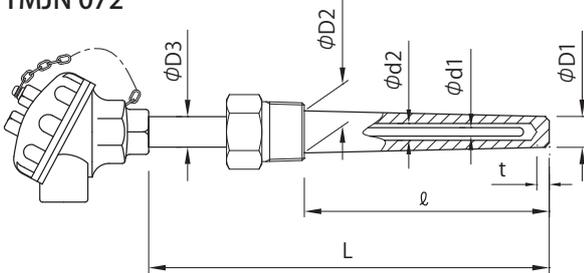
固定取付ネジ型式です。金属保護管をクリヌキにし、流体抵抗軽減、又、感度を良くするため、テーパを付けた耐圧仕様です。
