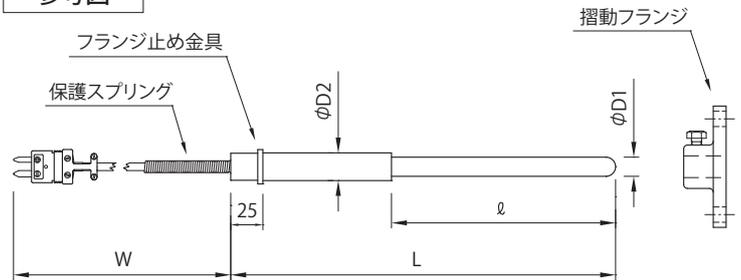
熱電対用コネクターにより着脱する仕様です。熱電対の取り換えが安易・確実です。又、端子筐が無い場合、取付スペースの狭い箇所でも使用できます。摺動フランジ等で取り付けられた場合に振動等で炉内に熱電対が落下するのを防止するための金具をつけてあります。
