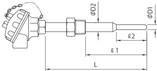
固定取付ネジ型式です。感度を良くするため保護管の感応部のみを細くし、端子筐支管までを同じ太さにした仕様です。
