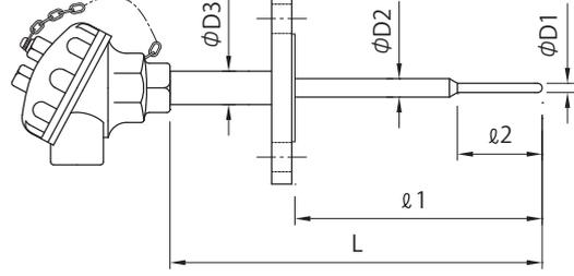
固定取付フランジ型式です。感度を良くするため保護管の感応部を細く、また、固定取付フランジまでのたわみを無くするためやや太くし、端子筐支管をさらに太く頑丈にした仕様です。
