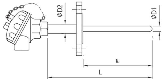
固定取付フランジ型式です。フランジ下すぐに磁性管を配した仕様です。
