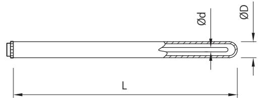
熱電対の取り換えを安易・確実にするため、結線部をコネクタにより着脱する仕様です。
