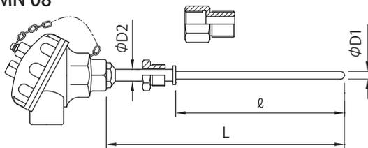
摺動取付ネジ型式です。ネジを締め付けた時の端子筐の向きが自在です。又、結線したまま、取付け、取外しができる仕様です。
