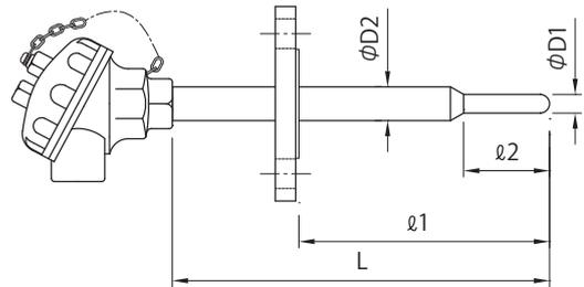
固定取付フランジ型式です。感度を良くするため保護管の感応部のみを細くし、端子筐支管までを同じ太さにした仕様です。
